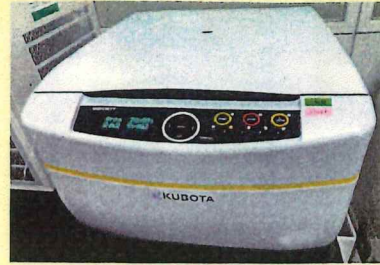
遠心分離機にかけ、固体と液体に分離します
