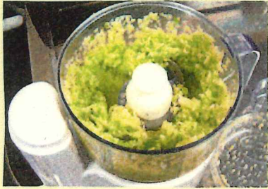
検体をフードプロセッサーで粉碎し、約 10 g 測りとります (種類ごとに使用部分は規定されています)
