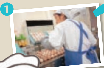
1 指定養鶏場から入荷した卵は、洗浄され、目視でヒビ割れなどの検品
