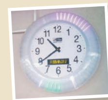
※時計の淵にあるLEDの色で電気の使用状況がわかります
